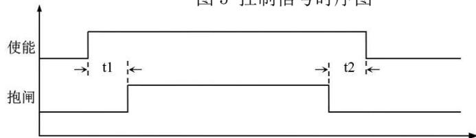
图 6 电机抱闸信号控制时序图
